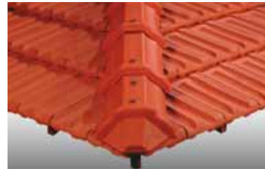
Arêtiers et bouts d'arêtier à emboîtement posés à sec, sur closoir ventilé, sans emploi de mortier.
