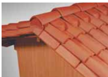
Emploi de closoirs cassons et bardelis "S". Fixation du fronton par vis et rondelle d'étanchéité.
